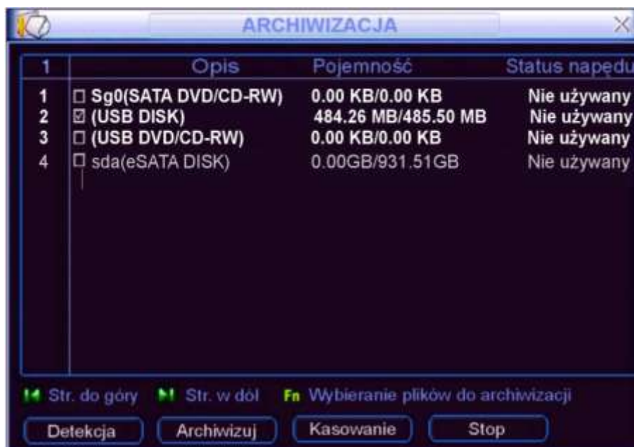
Rys. 4-26. Detekcja napędów do archiwizacji.
