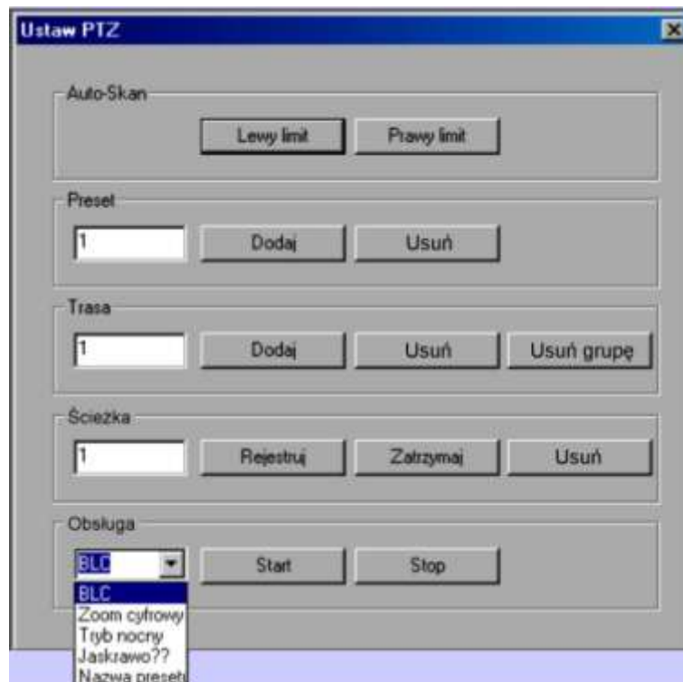
Rys. 7-16. Programowanie parametrów PTZ.
