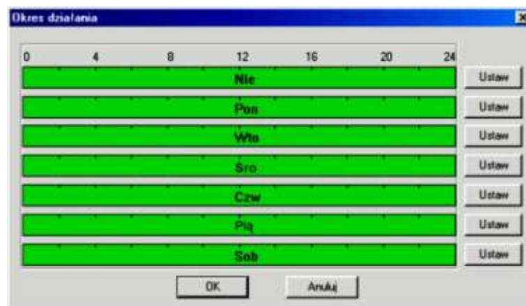
Rys. 7-38a. Ustawianie okresu aktywności wejścia alarmowego.
