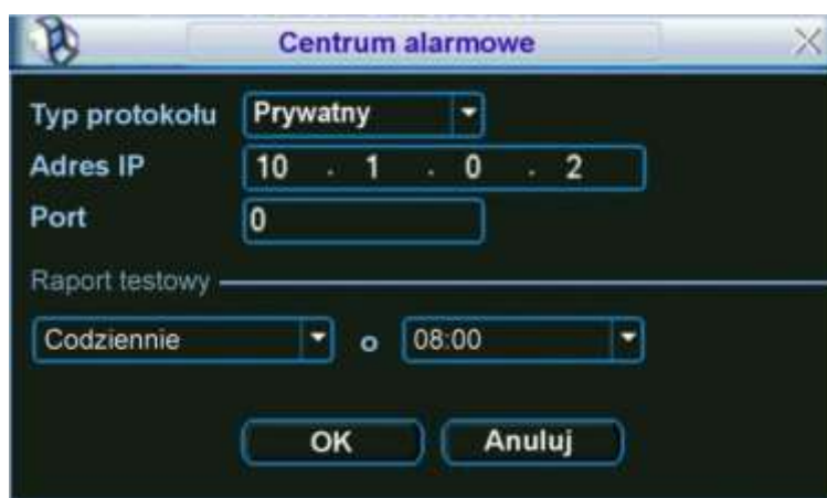
Rys. 5-17. Ustawianie serwera alarmowego.
