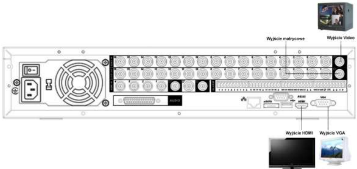
Rys. 3-2. Podłączenie monitorów do rejestratora.
