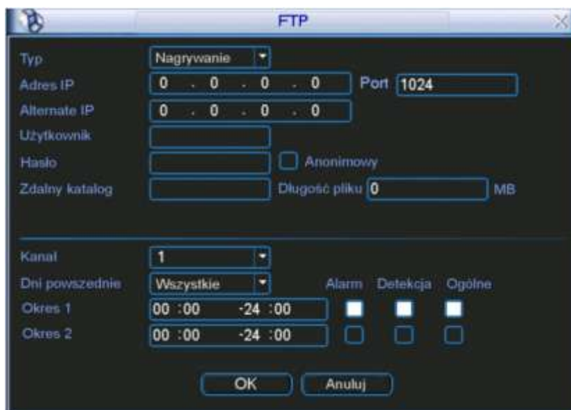
Rys. 4-16. Ustawianie parametrów serwera FTP.
