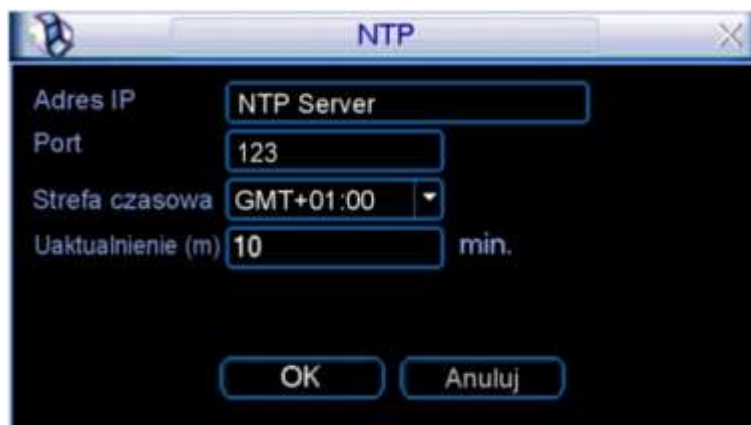
Rys. 5-10. Ustawianie parametrów NTP.
