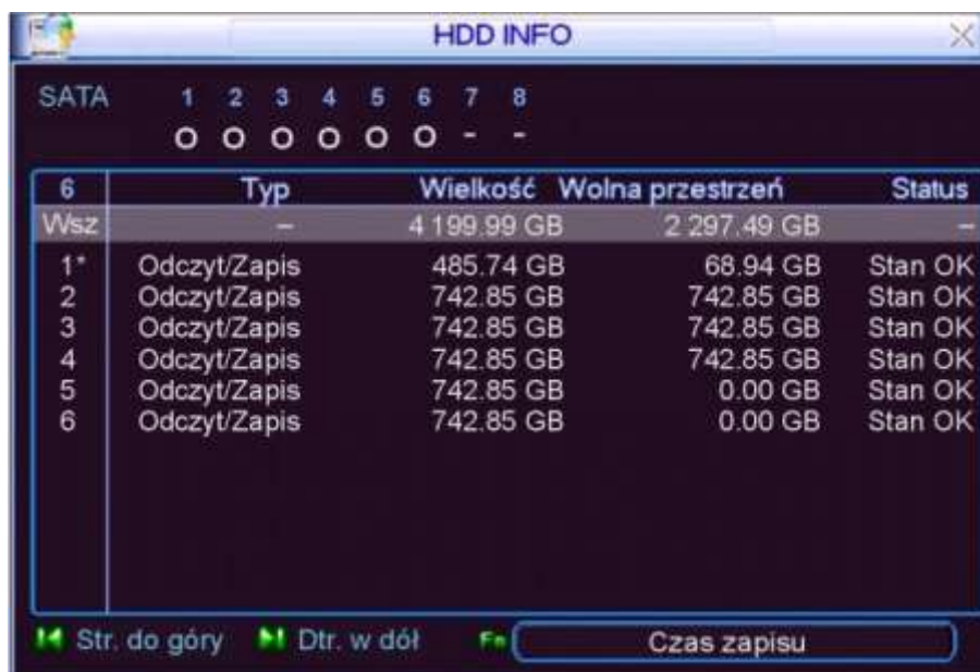
Rys. 5-41. HDD Info – pojemność dysków.
