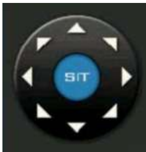
Rys. 4-32. Przycisk wielokierunkowy sterowania głowicą PTZ.
